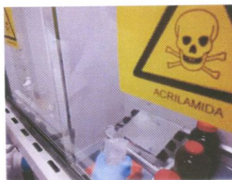
Preparació dels gels d'acrilamida a l'interior de la vitrina. Guillotina a 20 cm.
