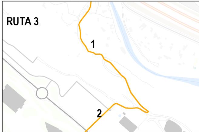
**Tramo 1.** Renovar el pavimento utilizando un material con alto coeficiente de rozamiento. Ampliar el camino hasta 3 metros de anchura. Condicionar la superficie pavimentada en cada giro para dar más seguridad y comodidad y para facilitar que se crucen varios usuarios.
