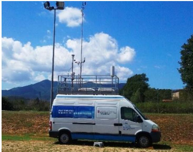
Les unitats mòbils són vehicles equipats amb analitzadors automàtics i captadors manuals per mesurar els contaminants atmosfèrics i sensors per a les variables meteorològiques. Complementen l'abast de la Xarxa de Vigilància i Previsió de la Contaminació Atmosfèrica (XVPCA), ja que permeten fer campanyes de mesuraments directes dels nivells de qualitat de l'aire en llocs on no hi ha vigilància de la xarxa.
