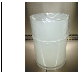
Fig. 8 Detalle soporte temporal para residuos cortantes/punzantes de cristal
