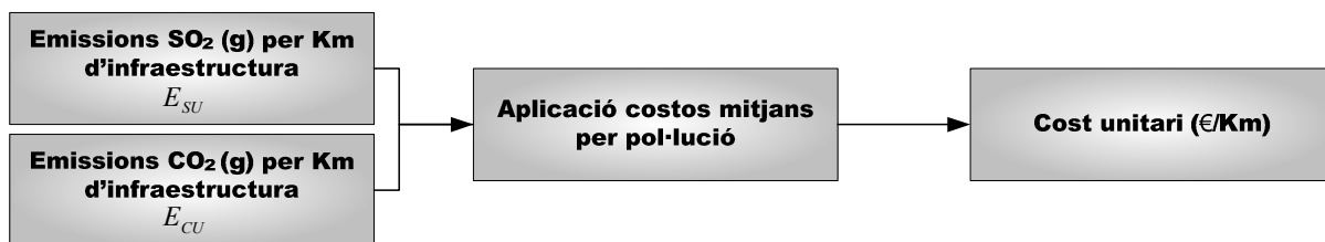
Esquema 39: Esquema de càlcul del cost relatiu als processos avant-post (Construcció i manteniment infraestructures).
