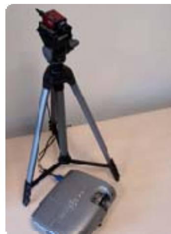
Càmera i canó de projecció utilitzats en l' scanning 3D
